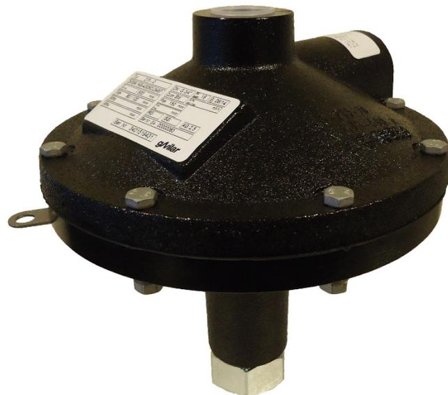
Das Sicherheitsabblaseventil 275 D ist hinter den Druckreglern installiert, um begrenzte Gasmengen zu entlasten. Wird dort eingesetzt, wo eine Entlüftung in die Atmosphäre akzeptabel ist. Dies ist eine kostengünstige Lösung, um zu verhindern, dass Sicherheitsabsperrventile bei Kriechlecks von Reglern ausgelöst werden.
