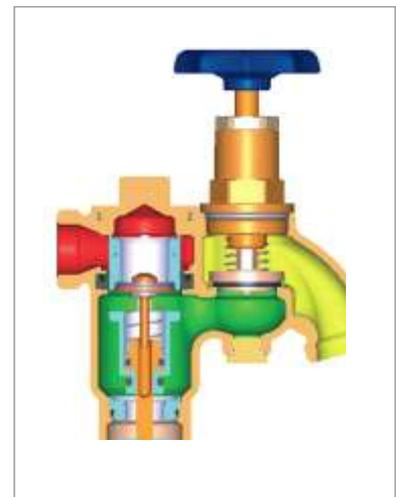
Bei Rücksaugung fällt der eingangsseitige Druck ab. Liegt die Druckdifferenz zwischen Vor- und Mitteldruckkammer wenig oberhalb 140 mbar, schließt der eingangsseitige Rückflussverhinderer und das Ablassventil öffnet. Bei Rückdrücken schließt der ausgangsseitige Rückflussverhinderer öffnet das Ablassventil.
